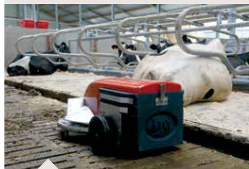
Lely Discovery shrnuje výkaly do otvorů mezi rošty pomocí pružné stěrky upevněné na spodku.
