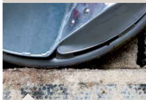
Zvláštní konstrukční jednotkou čističe stájí Discovery je prstenec na přední straně, který zajišťuje optimální kopírování zdi a objíždění překážek.
