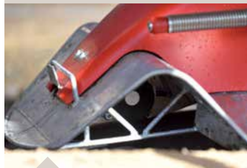
Vestavěný ultrazvukový senzor zajišťuje jízdu Discovery podél zdi v nastavené vzdálenosti.
