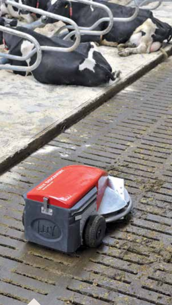
Lely Discovery čistič stáje se pohybuje po stáji, aniž by dojnice rušil.
