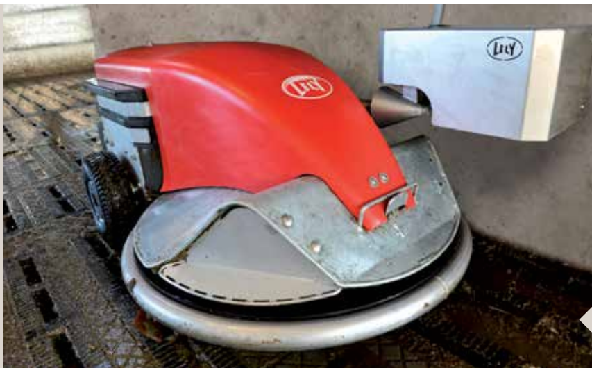
Lely Discovery shrnuje výkaly do otvorů mezi rošty pomocí pružné stěrky upevněné na spodku.
