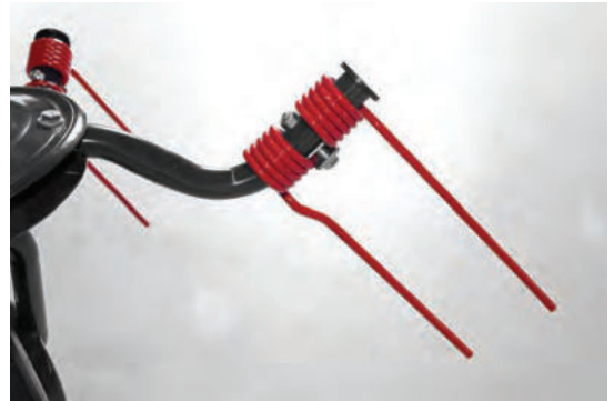
Držák prstů s pojistkou proti ztrátě
