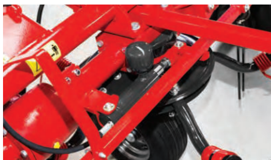
Všechny modely označené HS jsou standardně vybavené centrálním hydraulickým posunováním.
