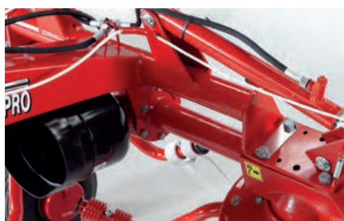
Přímý pohon se přenáší na rotor přes kloubový hřídel s bezpečnostní spojkou až k úhlové převodovce a dopředu přes robustní převodovku a dvojitý křížový kloub s hřídelí.
