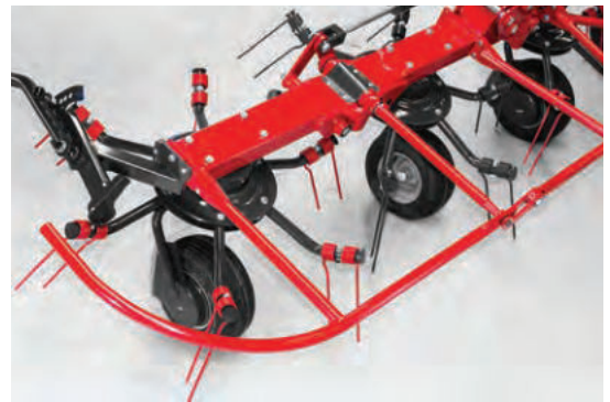
Propojené kryty pro zajištění dodatečné stability a tuhosti.
