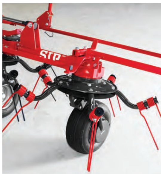
Rotor a ramena s pružinovými prsty jsou při otáčení vystavené působení velké síly, proto se vyrábějí z robustních trubek kruhového průřezu. Dodatečné vyztužení zajišťuje spodní kroužek na rotoru.
