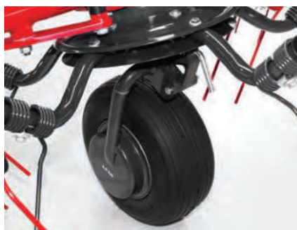
Kola s víceúhňovým nastavením výšky a rychlé nastavení úhlu rozhozu s koly, která lze posunovat.
