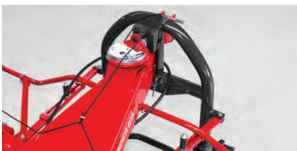
Kyvný čep se stabilizátory umožňuje snadné kopírování stopy traktoru.
