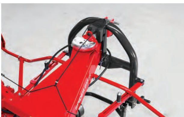
Kyvný čep se stabilizátory umožňuje snadné kopírování stopy traktoru.
