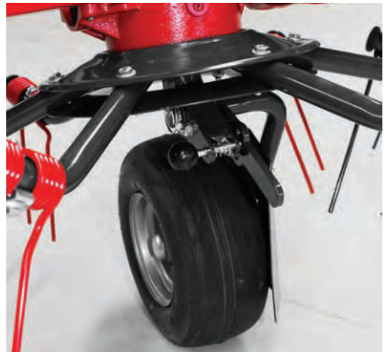
Kola s víceúhňovým nastavením výšky a rychlé nastavení úhlu rozhozu s koly, která lze posunovat.
