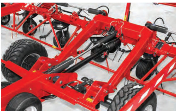
Promyšlený, hydraulický systém skládání umožňuje rychlé přípravě stroje pro práci, otáčení a přepravu, i snadné couvání během práce.
