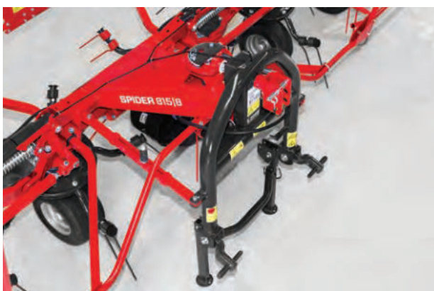
Kyvný čep se stabiátory umožňuje snadné kopírování stopy traktoru.
