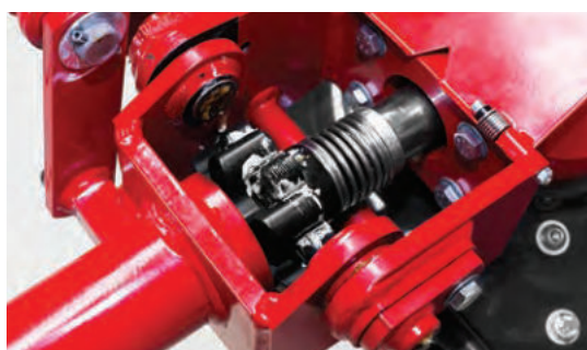
Dvojitý křížový kloub a zubová spojka uložené ve stabilní skříni garantují spolehlivý a tichý chod a bezvadné uložení.
