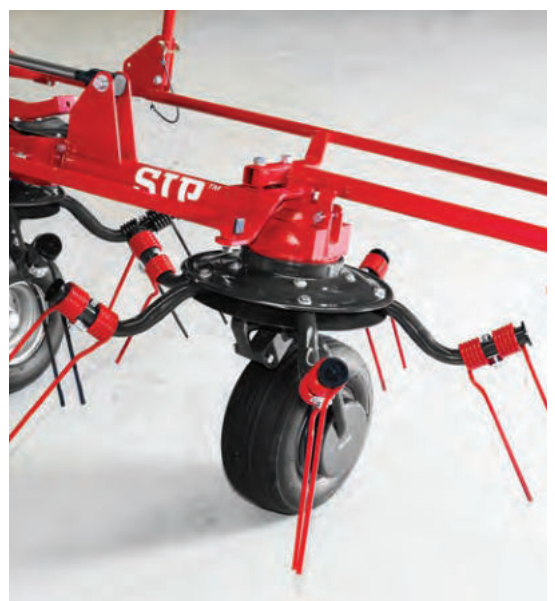
Rotor und ramena s pružinovými prsty jsou při otáčení vystavené působení velké síly, proto se vyrábějí z robustních trubek kruhového průřezu. Dodatečné vyztužení zajišťuje spodní kroužek na rotoru.
