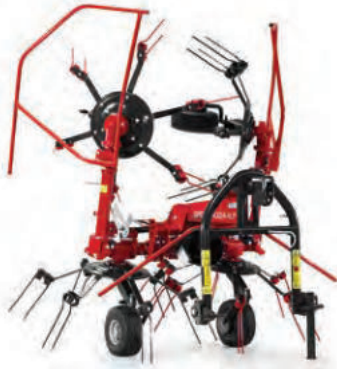
Systém pro rotaci externích rotorů za účelem dosažení menší přepravní šířky.
