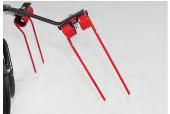
Držáky prstů s pojistkou proti ztrátě prstů
