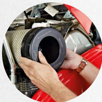
Průběžné čištění filtrem Piclon zajišťuje, že údržba filtru je provedena až je potřeba tím, že se rozsvítí příslušná kontrolka.
