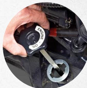
Kontrola hladiny oleje a doplnění bez potřeby zvedání kapoty motoru.
