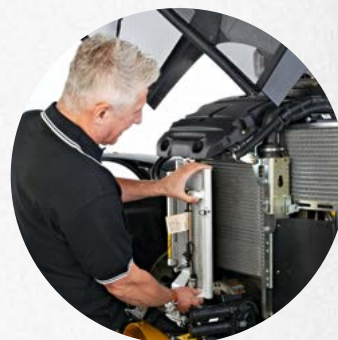
Rychlé a jednoduché čištění chladičů a klimatizace.
