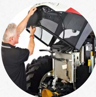
Jednodílnou kapotu motoru na plynových vzpěrách lze zvednout do polohy 45° dokonce s vpředu připojeným neseným nářadím.
