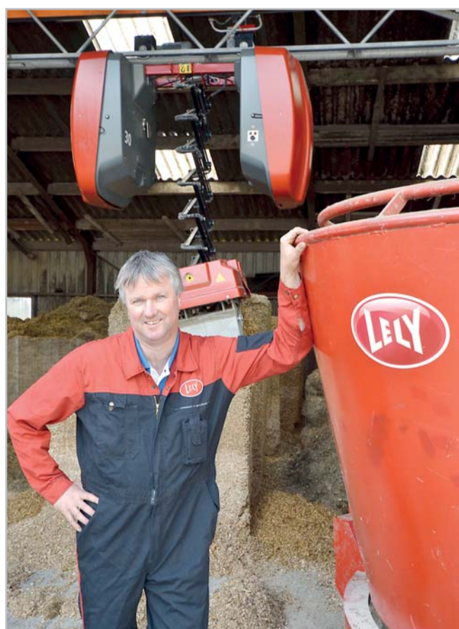
Automatický systém krmení Lely Vector tvoří portálový jeřáb, který nese elektronicky poháněný drapák s rozpětím čelistí téměř 150 cm, a 1300 kg těžký krmný vůz a přihrnovač krmiva v jednom Foto archiv firmy
