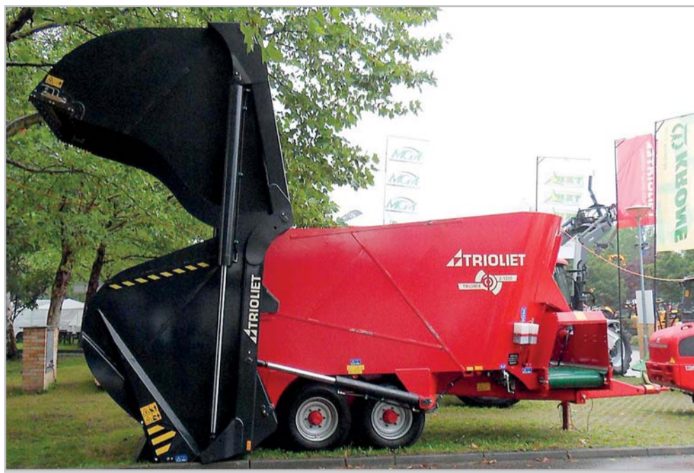
Některé vertikální modely v závěsném provedení se nabízejí s různě konstruovaným vykusovačem Foto Filip Javorek
