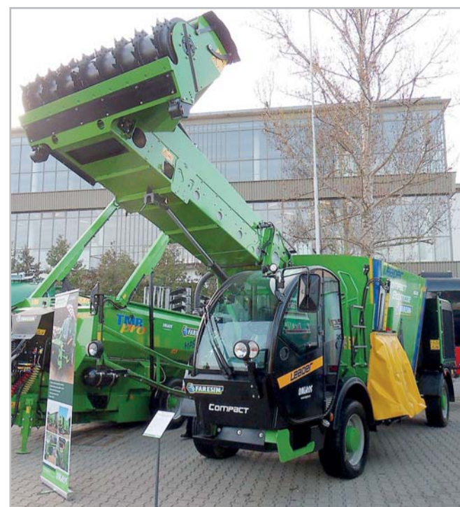
Hojně je mezi vertikálními MKV zastoupena kategorie samojízdných modelů s frézovacím plnicím zařízením Foto Filip Javorek
